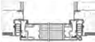
Exemple de pose sur tapée, épaisseur variable suivant l'isolation choisie.
