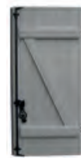
Volet à lames verticales avec barre et écharpe
